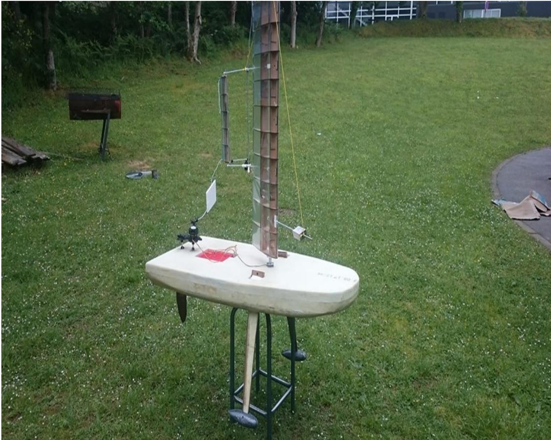
FIGURE 9: Bateau avec l'aile et le système de contre-poids
