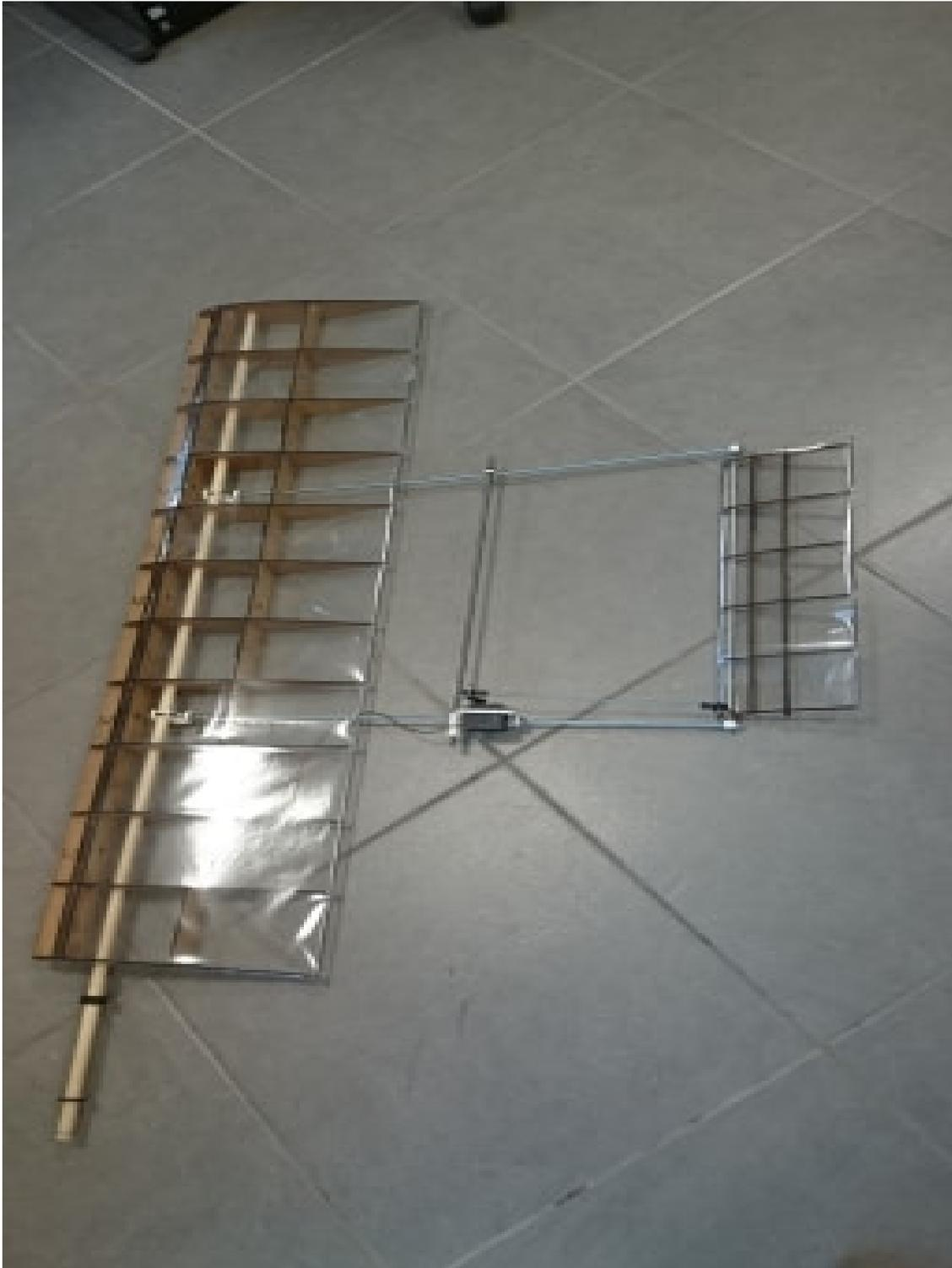
FIGURE 8: Aile avec aileron
