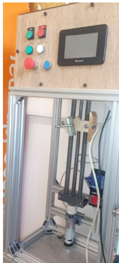
FIGURE 1 – système de glissière.
