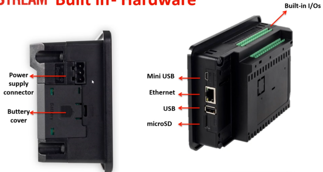
FIGURE 3.1 – Vue générale de l'automate UniStream US5-B10-T42
