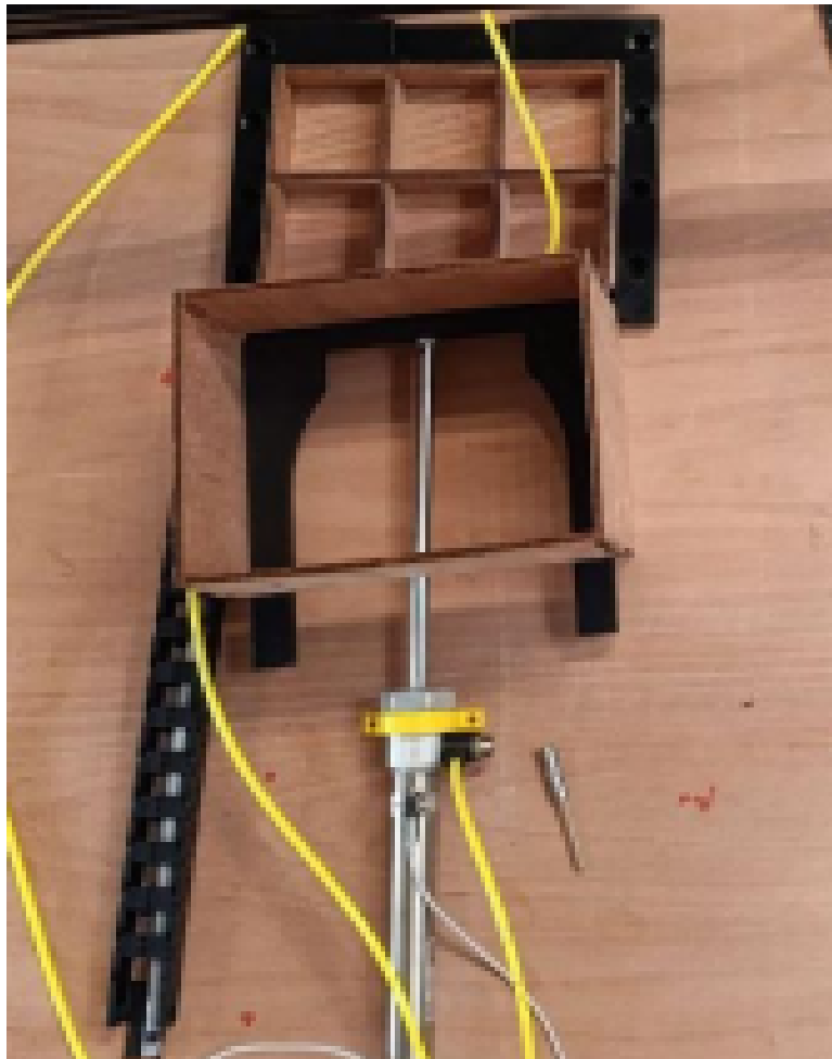
Figure 3: État initial du système : absence de support mécanique dédié pour le vérin
