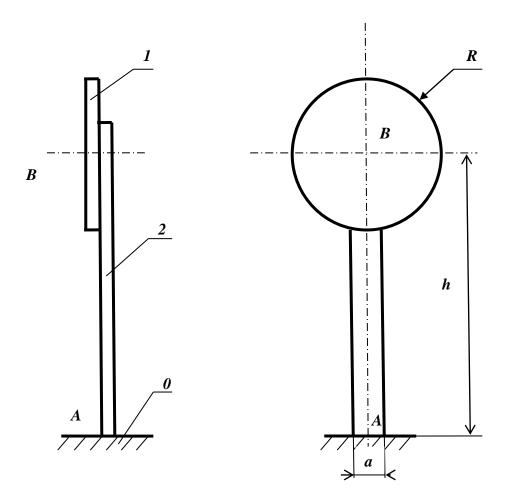
**1.1-** Déterminer le torseur  $\mathcal{T}_{v/2}$  associé aux actions du vent sur le poteau 2.
