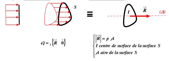
**1.2-** Déterminer le torseur  $\mathcal{T}_{v/1}$  associé aux actions du vent sur le panneau 1. Montrer que ce torseur est un glisseur.
