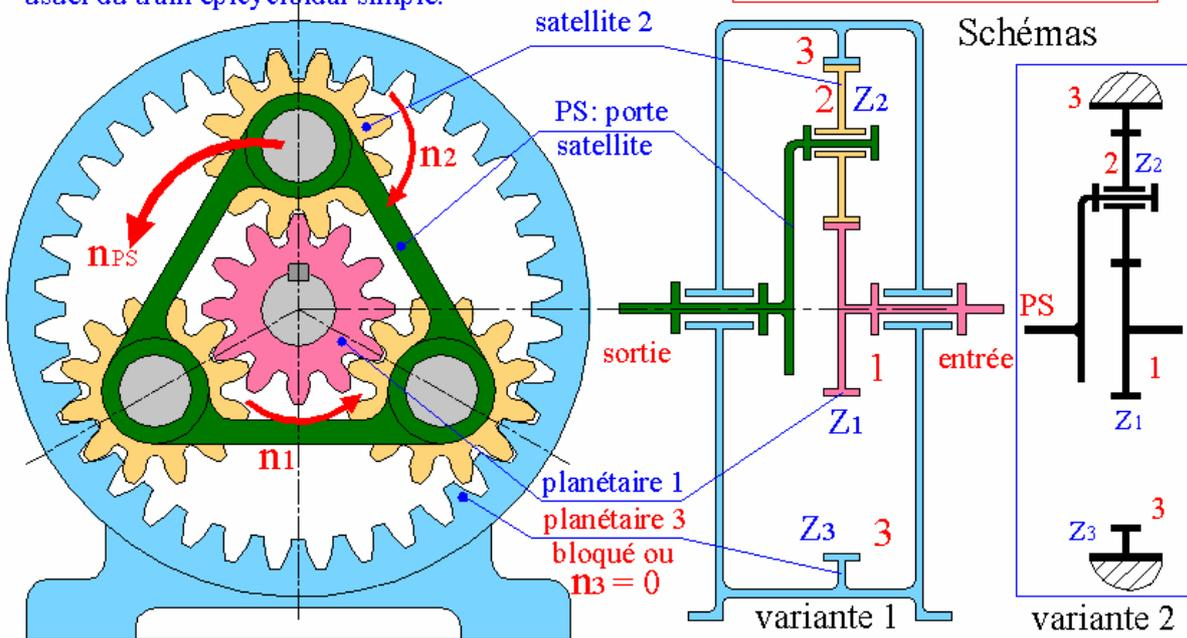
La configuration avec planétaire couronne 3 bloquée est de loin la plus utilisée : planétaire 1 en entrée et porte satellites PS en sortie.
