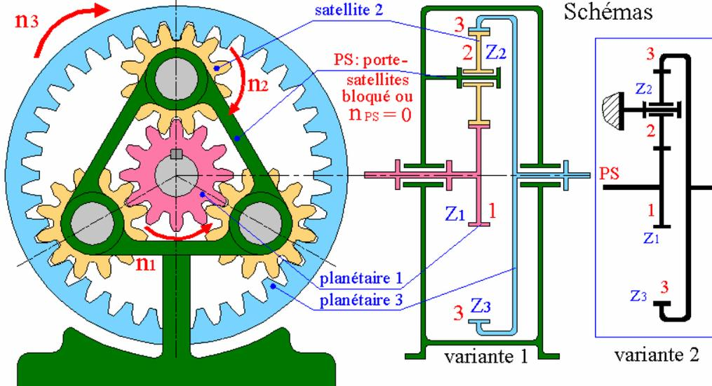
Si le porte satellites PS est bloqué, l'ensemble fonctionne comme un train classique à un engrenage intérieur avec roue d'inversion.
