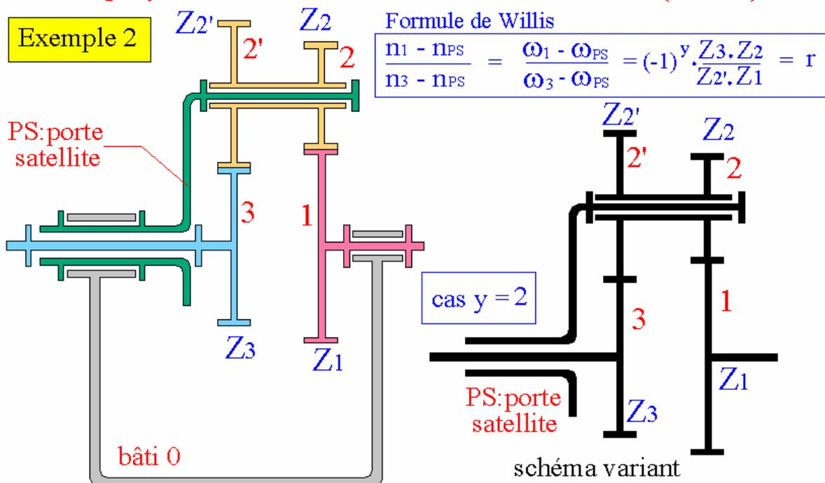
Ce type de trains épicycloïdaux permet de plus grands rapports de réductions. Le satellite est réalisé à partir de deux roues dentées  $\underline{2}$  et  $\underline{2}'$  dont le nombre de dents  $Z_2$  et  $Z_2'$  sont différents. Comme pour les trains épicycloïdaux simples, les trois cas de fonctionnement peuvent exister.
