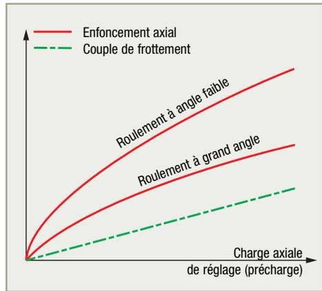
■ Jeu axial au montage pour deux roulements séparés
