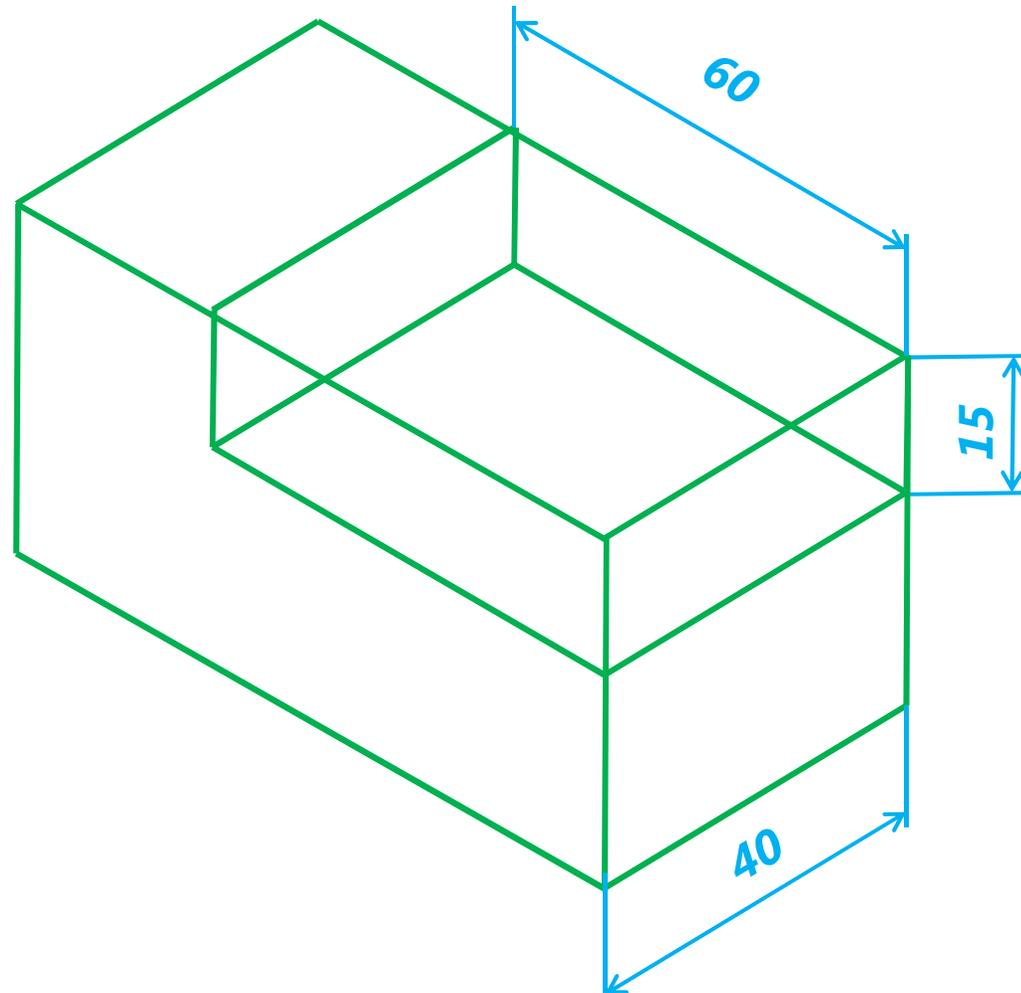
**Réalisation de l'entaille verticale: on construit un parallélépipède rectangle (40x15x60)**
