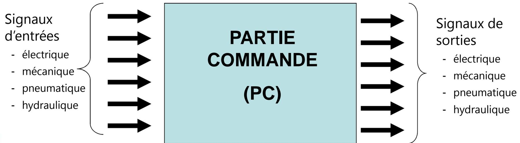
La logique interne de fonctionnement de la PC peut être décrite par différents langages indépendamment de la technologie utilisée.
