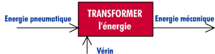
L'énergie mécanique est produite sous forme d'un mouvement permettant de provoquer un déplacement ou de créer une force.
