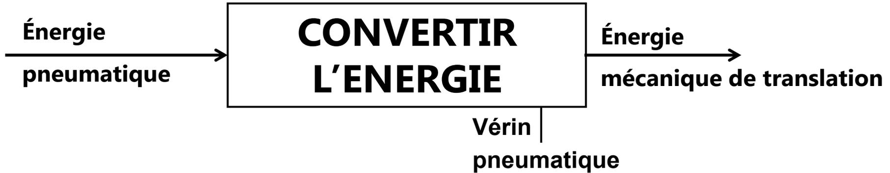
*Principe de fonctionnement*
