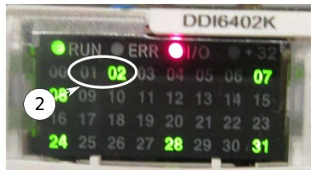
3. Lire aussi l'état des capteurs sur le module déporté d'entrées quand le vérin est sorti.
