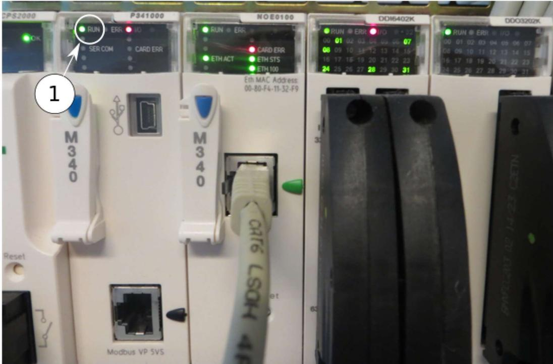
2. Lire l'état des capteurs sur l'automate quand le vérin est sorti.
