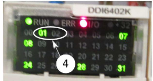
5. Lire aussi l'état des capteurs sur le module déporté d'entrées quand le vérin est rentré.
