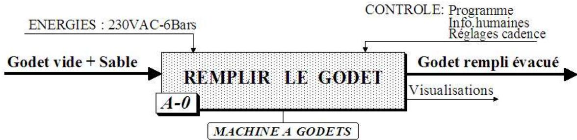
FIGURE 1 – Actigramme de la machine à godets
