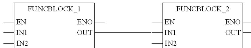
Lorsque EN est réglé sur 0 par FUNCBLOCK\_1, la liaison à la sortie OUT de FUNCBLOCK\_1 conserve l'ancien statut qu'elle avait lors du dernier cycle correct.
